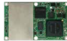
Advanced Trimble® BD970 OEM est un récepteur compact multi-constellation conçu pour offrir une précision centimétrique à une variété d'applications.
